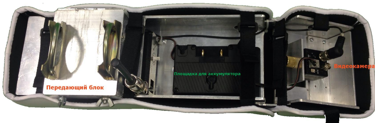
Передающий модуль с видеокамерой и площадкой для крепления аккумулятора
